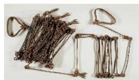
Désignation 1 : Chaines d'arpenteur Fonction : Mesure de distances
